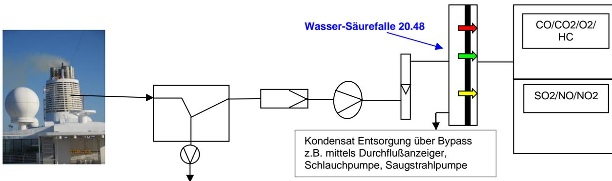
Bei hohen Schwefelgehalten in fossilen Brennstoffen, z.B. Schweröl/Heavy Fuel, helfen die Produkte Säurefilter und Absorber nur bedingt. Oftmals finden sich Säuretropfen auch nach der Gasaufbereitung. Diese werden über die Wasser-Säurefalle WT 20.48 abgeschieden und über den Bypass kontinuierlich entsorgt.
