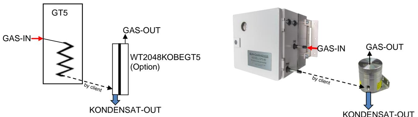
Der Prozess-Analysenkühler führt das anfallende Kondensat über externe Komponenten, z.B. Edelstahl-Wasserfalle Modell WT 20.48 KOBEGT5 (Option) ab. Diese Konstellation findet in der Überwachung von Wasserstoff und Sauerstoff bei der Elektrolyse Verwendung (siehe Anwendungsbeispiele).
