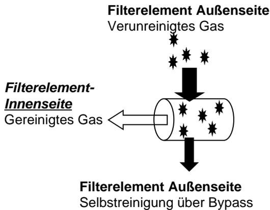
**Schematische Darstellung Koaleszenz Filtration: (Flüssigkeitsabscheidung)**
