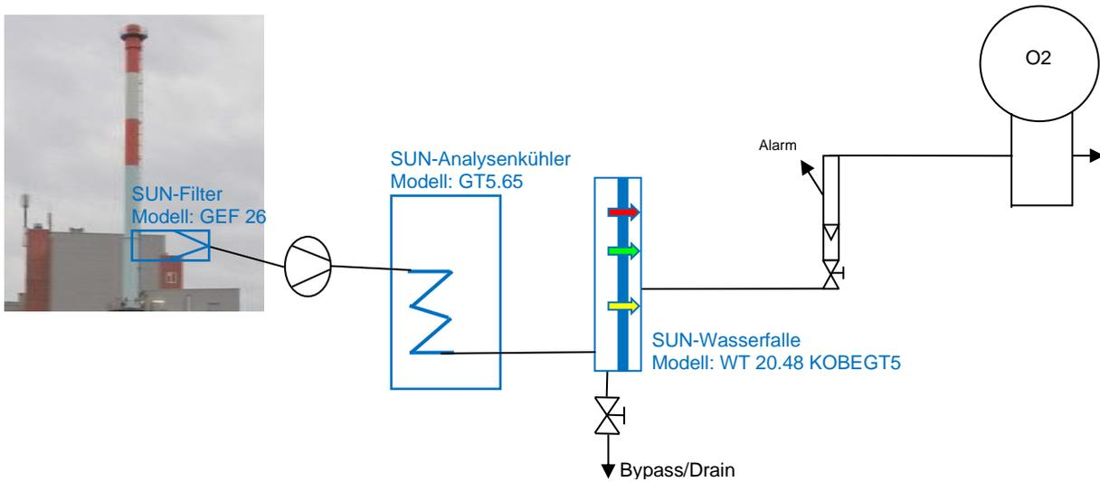
**Kurzbeschreibung:** Das Messgas wird über den Gasentnahmefilter (Modell GEF 26) vorgereinigt. Der Prozess-Analysenkühler (Modell GT5.65) kühlt das zu messende Gas ab, das anfallende Kondensat wird in der Wasserfalle separiert und durch eine manuelle Entleerung über ein Handventil oder Nadelventil abgeführt. Die Wasserfalle Modell WT 20.48 KOBEGT5 mit der eingebauten SUN-Control-Analytik-Membrane® schützt den hochwertigen Analysator vor eindringendem Kondensat und Feinststaub (Polzeifilter).
