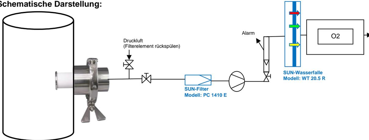
Das Messgas wird über den Gasentnahmefilter Modell GEF 26 vorgereinigt. Der Filter Modell PC1410 E ergänzt die Filterkette. Die Wasserfalle Modell WT 20.5R dient zur Feinfiltration und zugleich als Schutz vor möglichen Kondensateinbruch (Polzeifilter).
