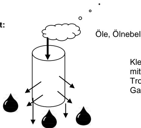
Kleinere Öltröpfchen und Ölnebel werden durch den Borosilikatfilter miteinander „verschmolzen“ (koaleszieren). Die entstandenen Tropfen werden durch den Hauptgasstrom mitgerissen. Der Gasstrom ist von Innen nach Außen gerichtet
