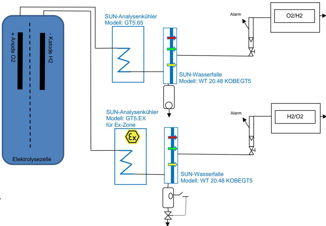
**Kurzbeschreibung:** Sicherheitsgerichtete Betriebsmessung von Sauerstoff (O<sub>2</sub>) und Wasserstoff (H<sub>2</sub>) an Elektrolyseuren zur Gewinnung von Wasserstoff. Im Zuge des Klimawandels wird verstärkt auf die Gewinnung von regenerativem Wasserstoff, sogenannter grüner Wasserstoff, gesetzt. Hierbei werden die Produktgase auf Gasqualität und Verunreinigungen mittels extraktiver Gasanalyse überwacht.
