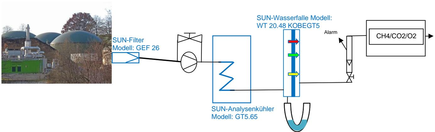
**Kurzbeschreibung:** Das Messgas wird über den Gasentnahmefilter (Modell GEF 26) vorgereinigt. Der Prozess-Analysenkühler (Modell GT5.65) kühlt das zu messende Gas ab, das anfallende Kondensat wird in der Wasserfalle separiert und über eine Tauchung abgeführt. Die Wasserfalle Modell WT 20.48 KOBEGT5 mit der eingebauten SUN-Control-Analytik-Membrane<sup>®</sup> schützt den hochwertigen Analysator vor eindringendem Kondensat und Feinststaub (Polzeifilter).
