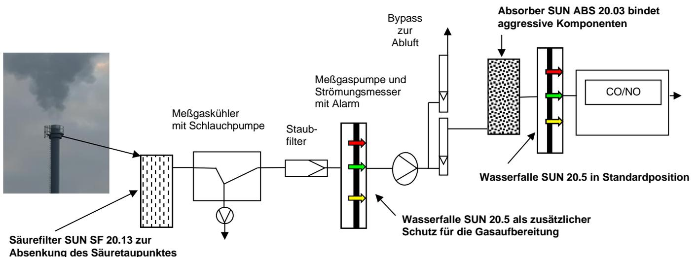
Bei großen Kondensatmengen kann über den optimalen Anschlußadapter (Schlauchanschluß 6/4 mm) manuell oder über eine zusätzliche Schlauchpumpe das Kondensat entsorgt werden.
