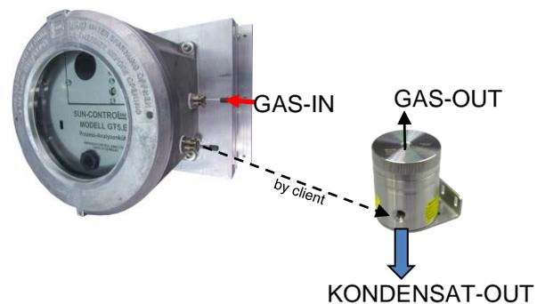
Der Prozess-Analysenkühler führt das anfallende Kondensat über externe Komponenten, z.B. Edelstahl-Wasserfalle Modell WT 20.48 KOBEGT5 (Option) ab. Diese Konstellation findet in der Überwachung von Wasserstoff und Sauerstoff bei der Elektrolyse Verwendung (siehe Anwendungsbeispiele).
